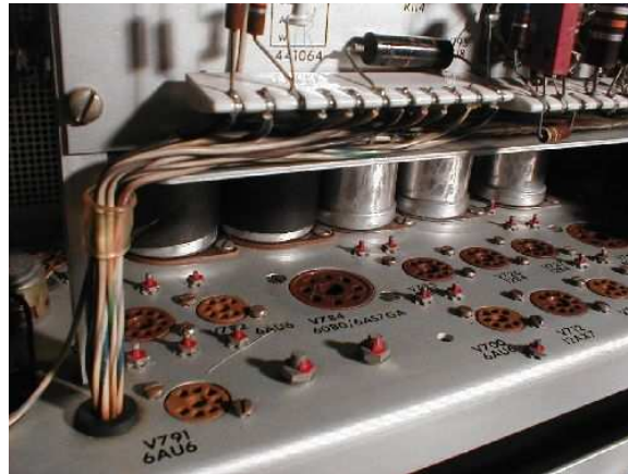
Figuur 4.3: Het buizen tijdperk.
